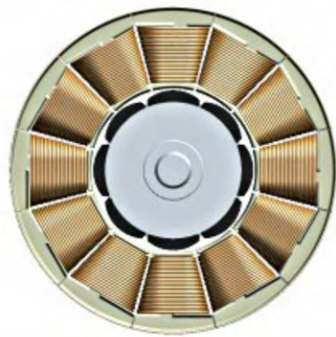
Ständerwicklung mit Läufer im Schnitt
