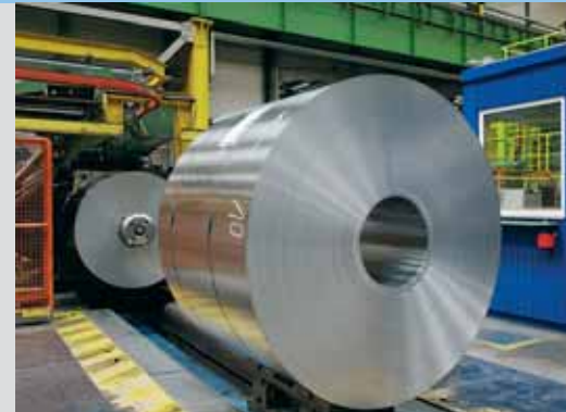
Coils an der Aufwickelgruppe Coils at the coiling section
