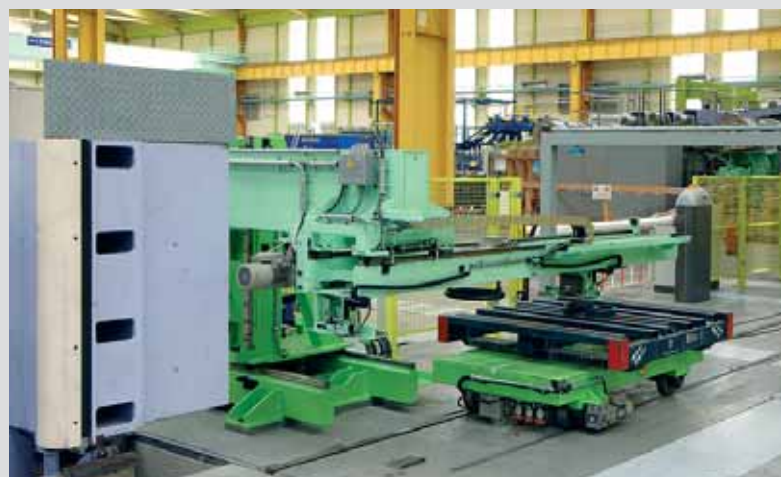
Automatische Palettenzuführung Automatic pallet feeding system
